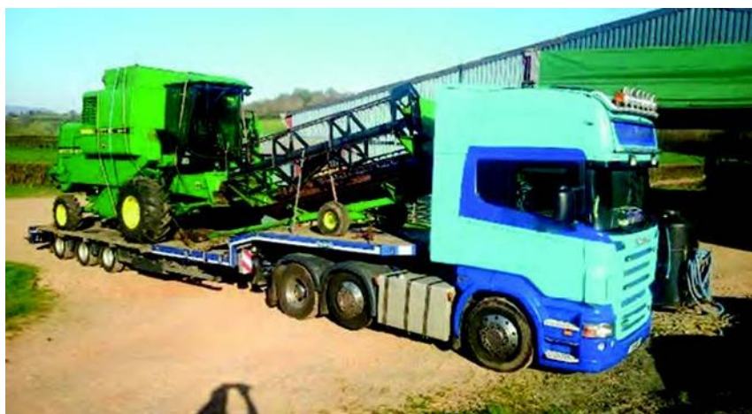
شکل ۱۰- بارگیری صحیح کمباین روی یدک‌کش (رستمی و همکاران، ۱۳۹۹)
