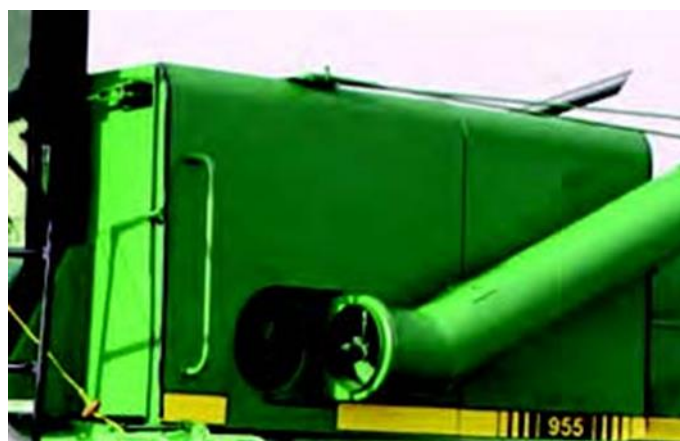
شکل ۹- نحوه استقرار لوله تخلیه دانه در زمان جابه‌جایی کمباین (امامی، ۱۳۹۷)
